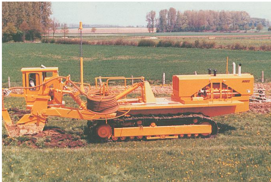
Slika 16: Polagač drenova u obliku pluga
